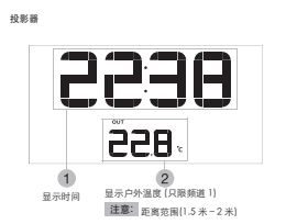
显示时间 显示户外温度 [只限频道 1] 注意：距离范围(1.5 米 - 2 米)
